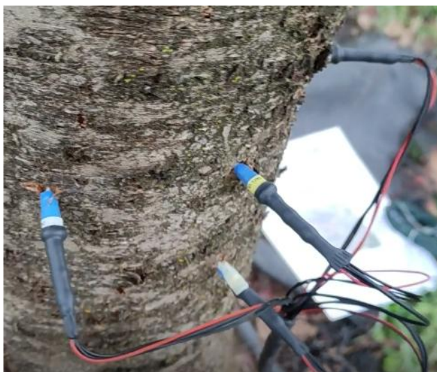
Figura 12 : Colocación de las sondas del sensor
