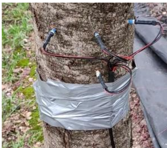
Figura 13 : Cable del sensor fijado
