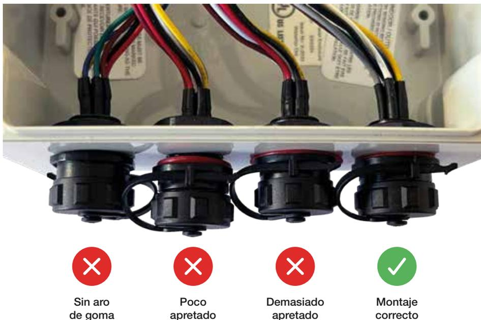
Ilustración 24: Comprobación de conectores de sensores
