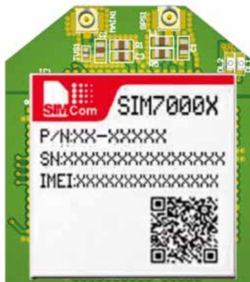
Ilustración 17: Módulo de comunicación GPRS
