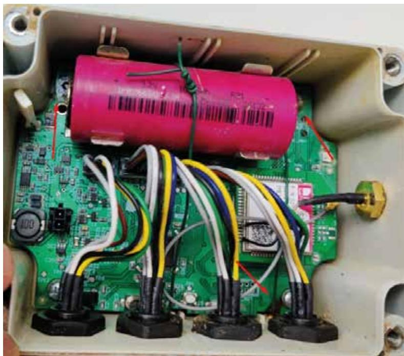
Ilustración 31: Cesens Mini con entrada de agua
