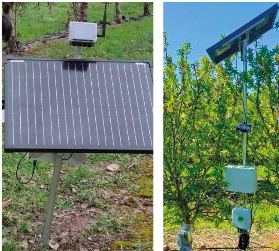
Ilustración 23: Estación con caja de alimentación y panel solar para sensor de savia
