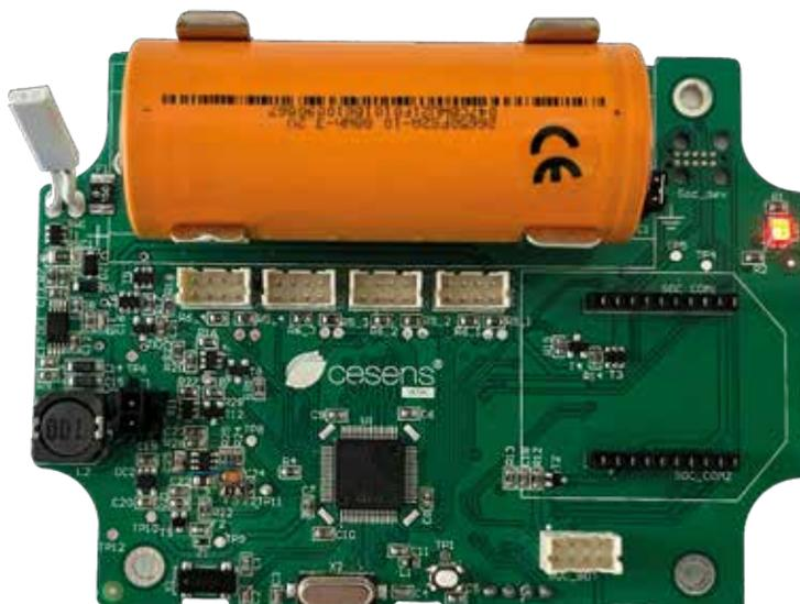
Ilustración 9: LED avisando de batería colocada al revés
