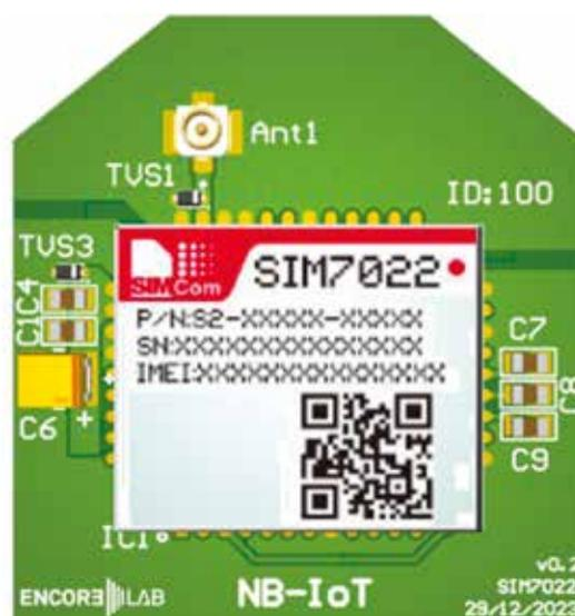
Ilustración 18: Módulo de comunicación NB-IoT
