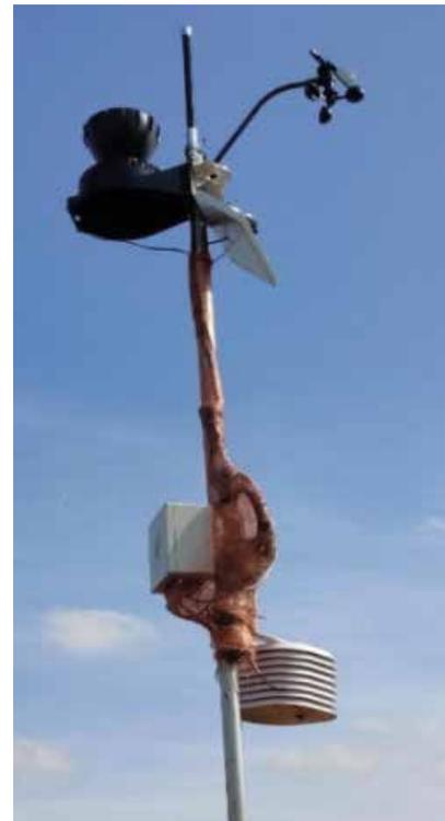
Ilustración 27: Estación protegida con malla metálica
