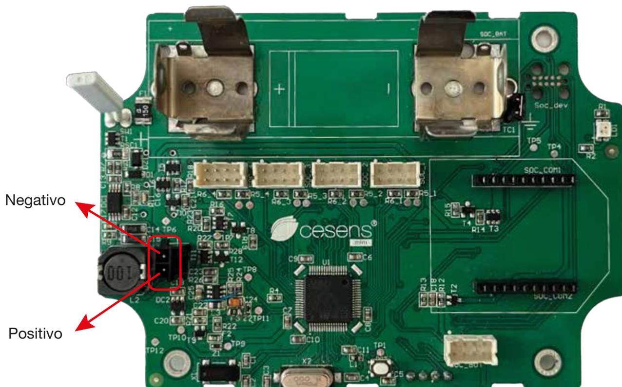
Ilustración 12: Socket del panel solar
