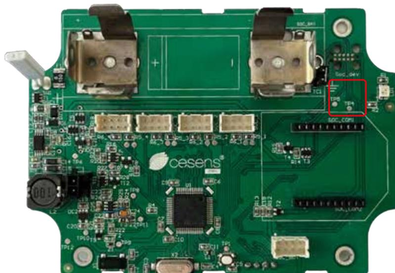
Ilustración 14: Socket del programador
